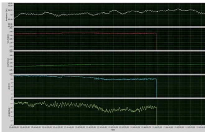
Rys. 3. Przebiegi parametrów kryterialnych procesu łączeniowego – operacja zamykania pierścienia
