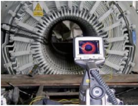
Fot. 10. Stanowisko do badania rozkładu temperatury na powierzchni żelaza czynnego stojana generatora w czasie indukcyjnego grzania przy użyciu zestawu termowizyjnego ThermaCam P60
